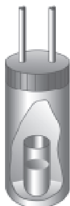
Барокамера-капсула, предназначенная для криоконсервации небольших объектов
